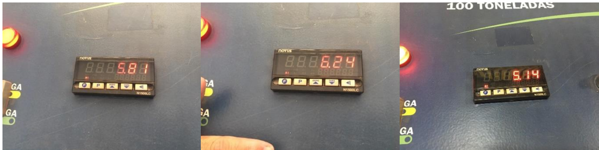
Figura 7. Valores apresentados pela prensa, em toneladas.
