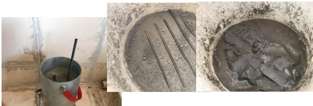
Figura 2. Vergalhões imersos no rejeito de minério
