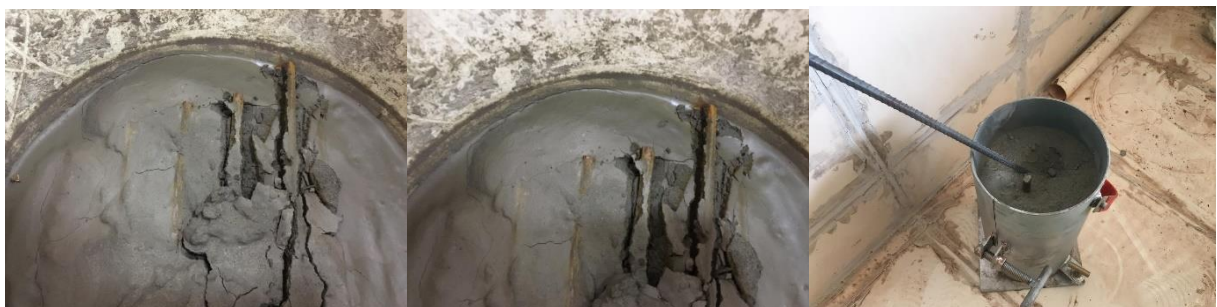
Figura 9. Ferragem imersa no rejeito de minério úmido e seco.
