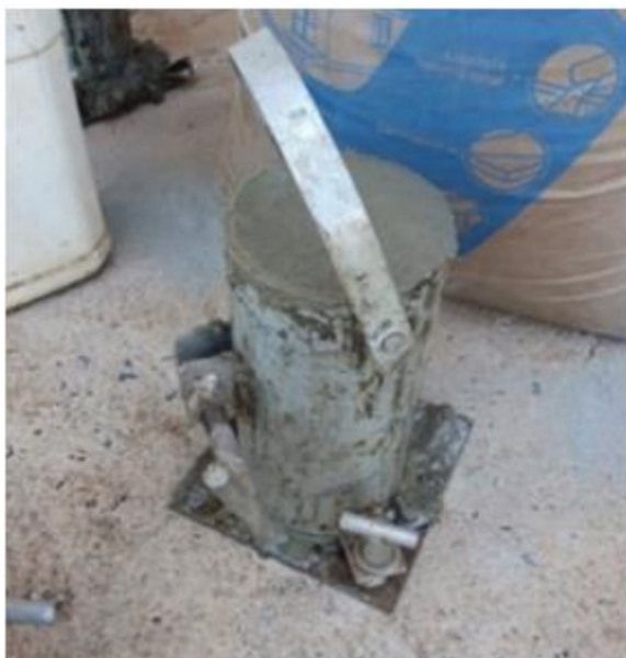
Imagem 2 – Moldagem do corpo de prova.
